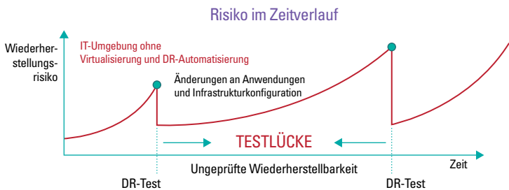
ABBILDUNG 2-2: Ohne regelmäßige Tests kann keine zuverlässige Wiederherstellung gewährleistet werden.
